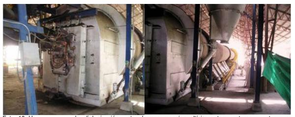
Foto 10 Horno proceso de clinkerización; estos hornos manejan altísimas temperaturas y antes eran monitoreados por un operario, en la actualidad se monitorean por sistema, aunque en ocasiones se debe ir directamente.
