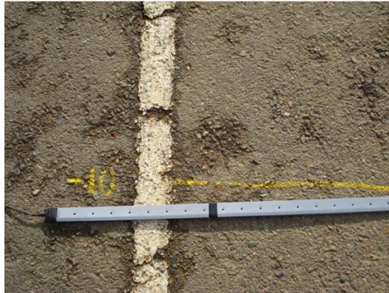
Foto 8. Receptor para la detención del cronómetro. Medición 10 metros.
