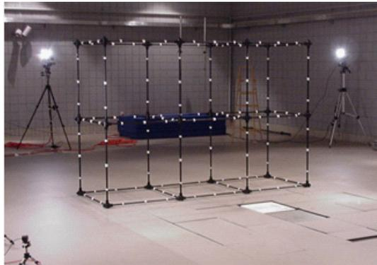
Figura 3. Sistema de referencia marcado con un sistema de puntos de control: las coordenadas espaciales de los puntos de control son conocidos.
