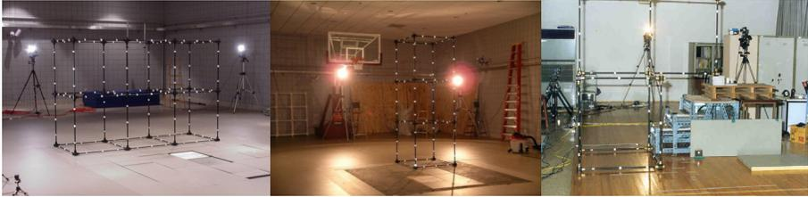
**Figura 8.** Polimorfismo: dependiendo del tamaño y la forma del volumen-control requerido y de lo que las circunstancias requieran, la forma del marco de calibración puede ser cambiada. Una vez que el marco es ensamblado, éste, llega a convertirse en un marco fijo y las coordenadas espaciales de los puntos de control pueden ser fácilmente obtenidas.
